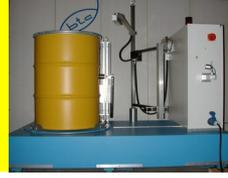
Der Gebindemonitor gemXnn dient der Bestimmung der Dosisleistung an Rundgebinden, insbesondere von 200 l – / 400 l - Abfallfässern. Mit geringem Aufwand ist eine Umstellung auf andere Gebindegrößen bei ähnlicher Geometrie möglich (z.B. VBA). Der Zusatz nnn kennzeichnet die Auslegungsgröße.
