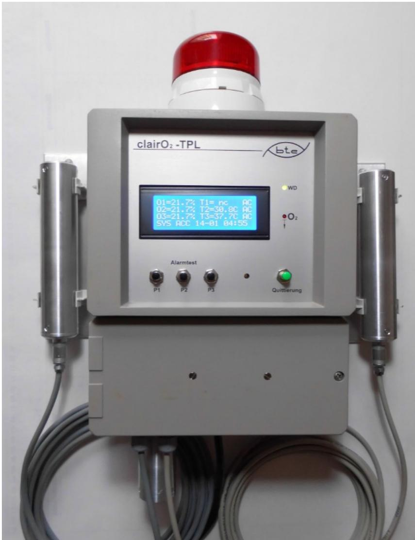
Der O<sub>2</sub>-Monitor „clairO<sub>2</sub> TLP“ dient der Arbeitsplatzüberwachung auf Einhaltung der für den Menschen notwendigen Sauerstoffkonzentration. Er basiert auf den seit 2 Jahrzehnten bewährten Monitoren „clairO<sub>2</sub>“ und „clairO<sub>2</sub>dp“ und entspricht nun dem aktuellen Stand der Kommunikationstechnik. „TLP“ steht für „triple probe & LAN“, d.h. max. 3 Sonden sind anschließbar, der Monitor kann in ein betriebliches LAN-Netz eingebunden werden.
